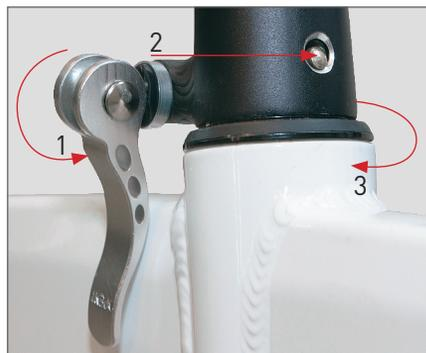
5. Ослабьте эксцентрик на рулевой колонке **(1)** и, нажимая на круглый фиксатор **(2)**, поверните руль направо примерно на  $45^\circ$  **(3)**, после чего, надавив ногой на переднюю часть рамы **(4)**, плавно потяните за руль вверх, отсоединив его от велосипеда.
